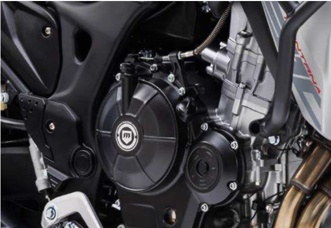
MOTOR BICILINDRICO 4 TIEMPOS, 8 VALVULAS, 498 CC, 47 CV / EMBRAGUE ANTIRREBOTE
