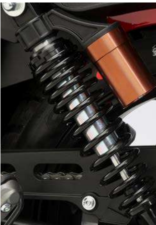
DOBLE AMORTIGUADOR CON DEPÓSITO GAS SEPARADO
